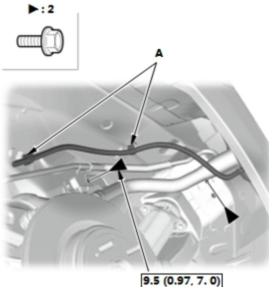
3. 拆下燃油加注口盖适配器盖 (A)。
